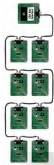
従来の接続構成 各バッテリーを有線でモニター
