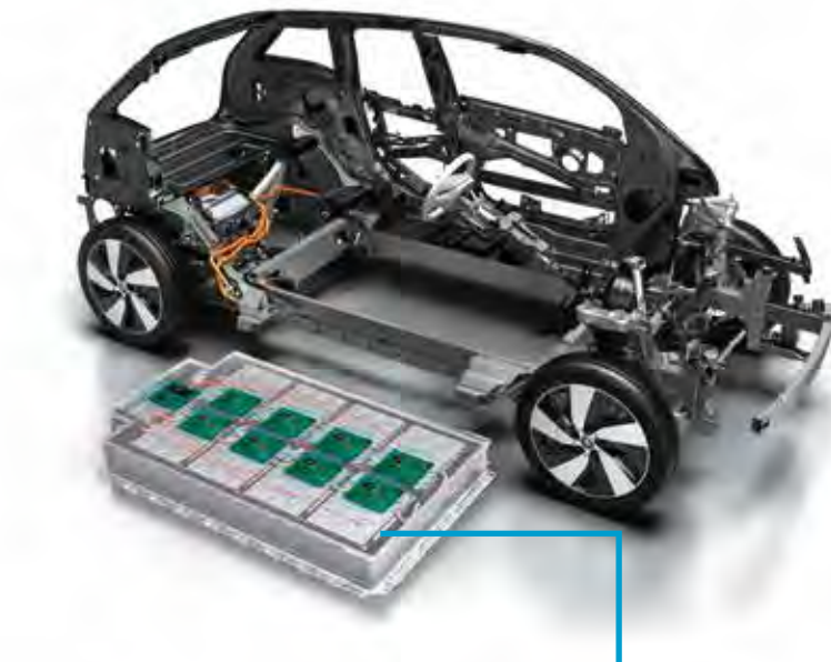
従来の接続構成 各バッテリーを有線でモニター
